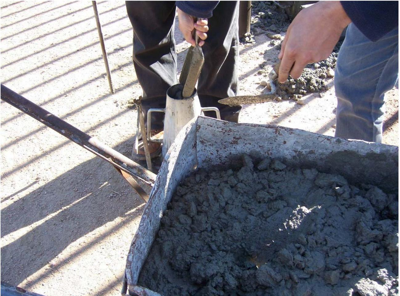
**Fig. 4** Riempimento del cono di Abrams con calcestruzzo fresco.
